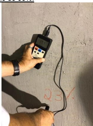
Foto ilustrativa 4: Medição do índice de umidade.
