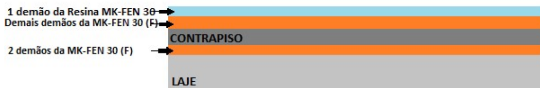
Figura 1: Croqui de detalhamento - sistema sanduíche.
